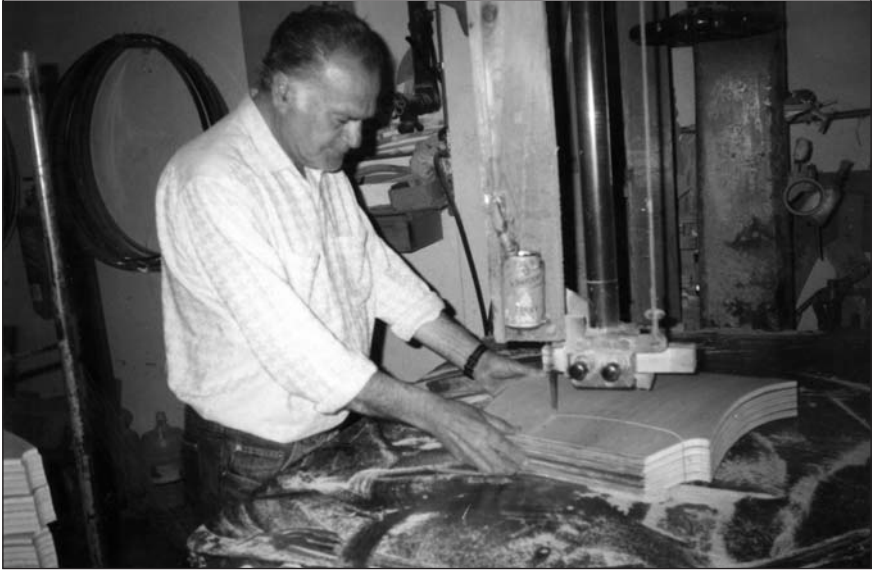
L'aparell de serrar segueix sent una eina imprescindible de bugir la fusta i els taulers dels seients de la cadira. Al retrat Fabià Ferrer Tárrega el Santero .
