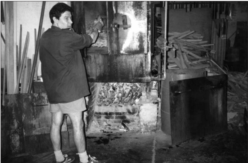
Antigament la caldera d'aigua sota el forn de llenya, era el sistema rudimentari emprat per vaporitzar la fusta.
