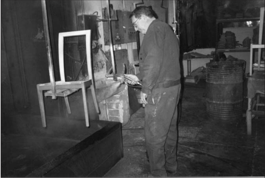
El quadre de pintura està definit per l'engranatge d'una cadena rotativa que porta incorporats una sèrie de ganxos on van col·locades les cadires. A la foto Ricardo el Carinyo .
