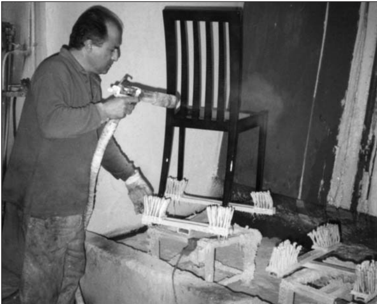
El procés de lacat es porta a terme dins d'una cabina de pintura, que disposa d'una base giratòria amb quatre punts, on es posa la cadira. Al retrat Esteban Monzó.
