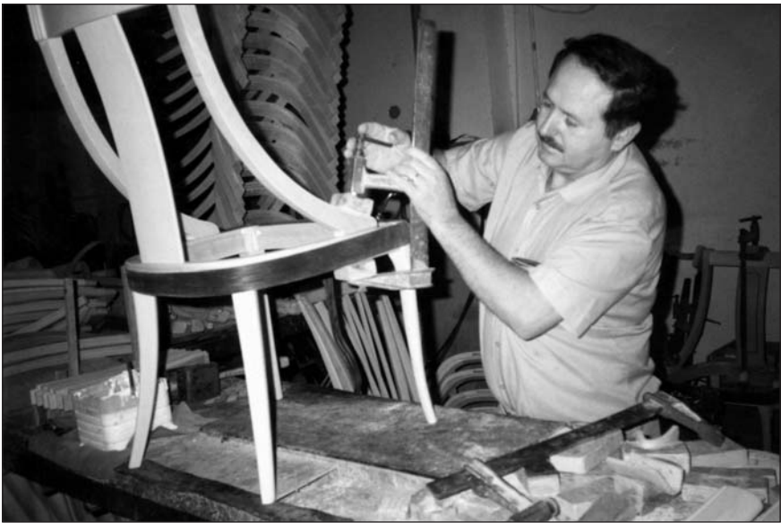
Al muntatge de la cadira encara s'utilitza el cercle de xapa de ferro i els gats de ferro colat, de forma artesanal.
