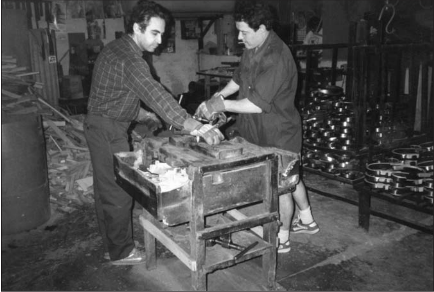
Una vegada corbada la peça, es posava en un motle i es fixava mitjançant un cercol de xapa de ferro.
