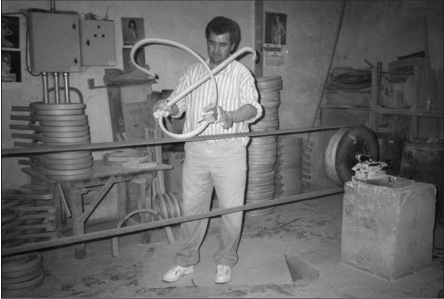
A través de les cintes de paper de vidre, s'escataven les complexes formes del moble corbat.
