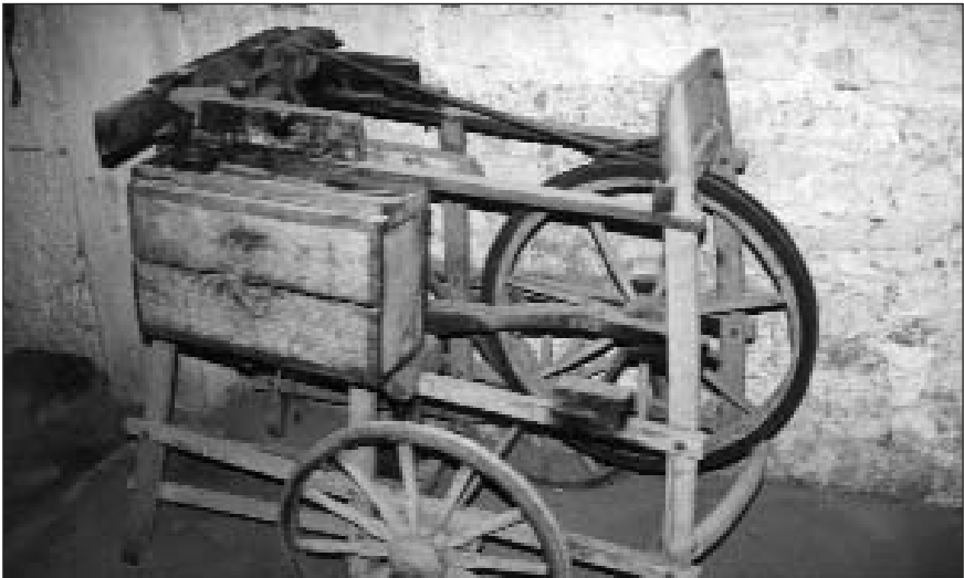
Carret d'esmolador de principi de segle. Provist d'un mecanisme molt senzill, aquest aparell funcionava per mitjà d'un pedal o palanca que bombejava amb el peu l'esmolador des del seu seient mentre esmolava tisores, ganivets, navalles de barber, gúbies i tota mena d'eines de torner. La seua presència va ésser habitual pels carrers del poble fins la meitat del segle. Sebastià Alfonso Gil (1858–1929) i la seua dona Pasquala Sanz Medina (1862–1948) vestits de la manera tradicional valenciana de la fi del segle XIX.
